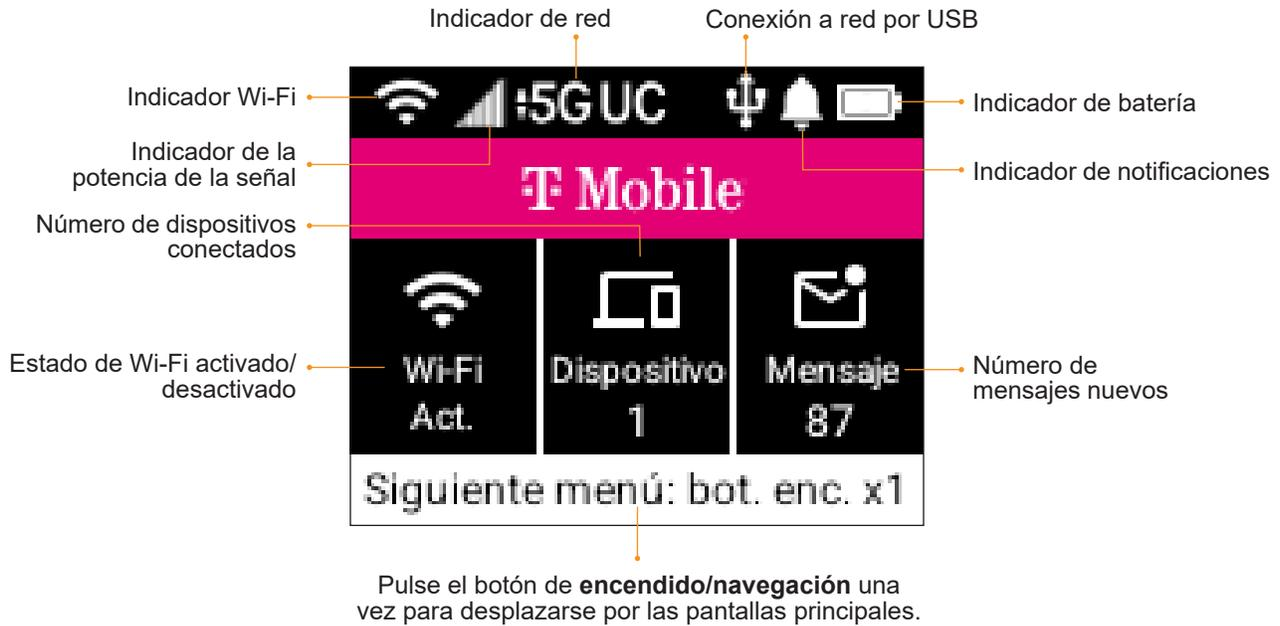
Nota: La pantalla se apagará tras 30 segundos de inactividad para ahorrar energía. Pulse el botón de **encendido/navegación** una vez para activar la pantalla. Esta configuración predeterminada se puede modificar en la interfaz de usuario web ([http://mifimanager.o\\_192.168.0.1](http://mifimanager.o_192.168.0.1)) en **Sistema > Dispositivo > Apagar pantalla**.
